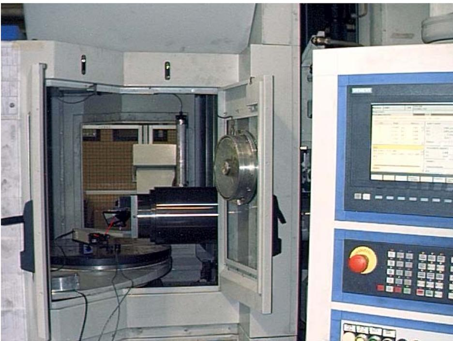
**Fig 1-Macchina sotto misura con il laser sul pianale e lo specchio sul mandrino.**
